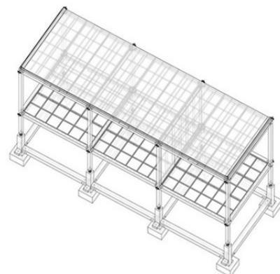
17 . estructura de pavimento: correas clavaderas 3 x 4 / 48 fijadas a placas de madera contralaminada maciza colocación de aislante acústico celulosa proyectada
