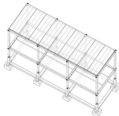
12 . estructura horizontal superior paneles autoportantes placas madera y lana de roca: 96 x 12 x 300 fijados a vigas superiores
