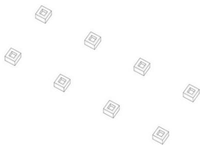
01 . fundaciones : zapatas aisladas prefabricadas, 0.7 x 0.7 x 0.4 mtrs niveles de fundación a partir del perfil topográfico del terreno: -1.7, - 2.2, - 2.7, -3.2, -3.7 mtrs.
