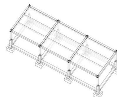
08 . estructura horizontal inferior placas madera contralaminada maciza tricapa: 12 x 96 x 288 apoyadas en escuadras perimetrales, juntas solapadas
