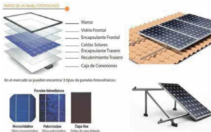
Figura 5.4.1 Paneles Fotovoltaicos
